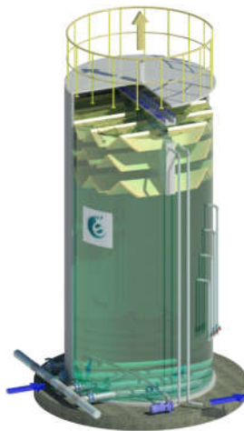
Hình 1.1. Mô hình bể UASB dạng bồn thép
